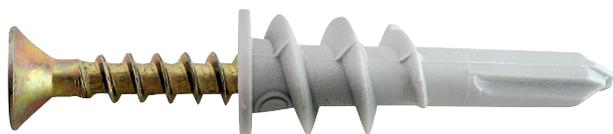
El taco Auto perforante DT 12 esta provisto de una punta tipo mecha, que le permite perforar la placa de yeso simplemente con el uso de un destornillador manual, y logra el anclaje por medio de su helicoide, que se rosca en la placa, formando una fijación hembra, la cual se completa con el tornillo provisto, que permite la fijación de cualquier pieza de hasta 12mm de espesor.
