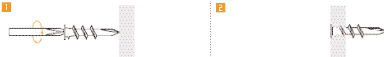
Coloque el taco en un destornillador. Presione y gire sobre el material base para lograr la perforación. Deberá perforar hasta que el nillo quede al ras con la superficie del material base.
